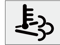
EGT warning lamp
