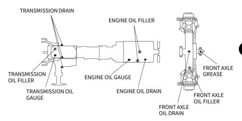
● FILLER HOLE ● GREASING POINTS ▲ DRAINS ■ WINDOWS
