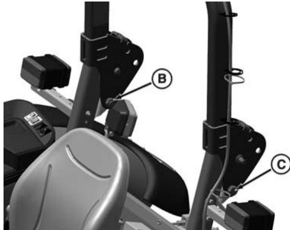
볼트 및 너트 설치
