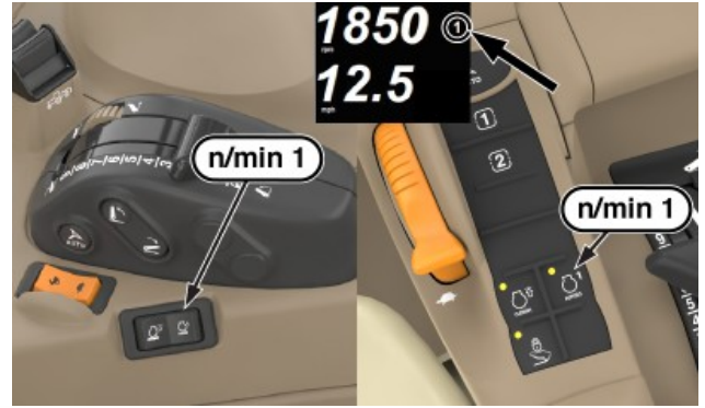
LX665605—UN—16MAR26 측면 콘솔 장착/CommandARM 장착
