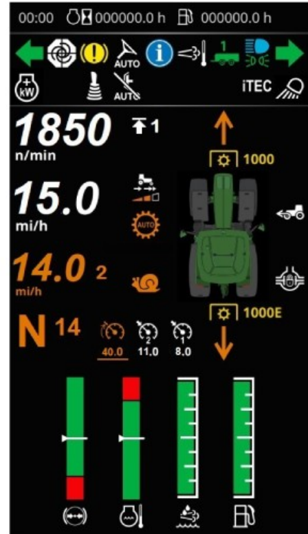
LX665578—UN—04MAR26 추가 CommandCenter 장착 코너 포스트 디스플레이.
