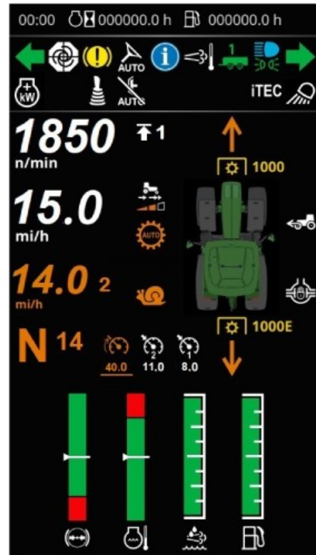
LX665578—UN—04MAR26 추가 CommandCenter 장착 코너 포스트 디스플레이.
