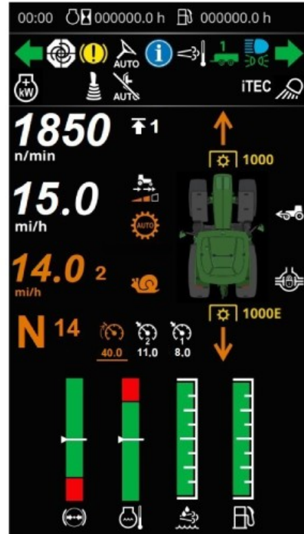
LX665578—UN—04MAR26 추가 CommandCenter 장착 코너 포스트 디스플레이.
