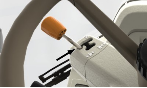
e19에 주차 잠금장치 체결(CommandX 구동 레버 미장착)
