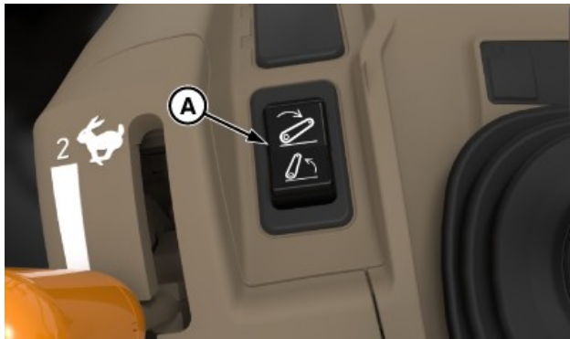
A—빠른 상승/하강 스위치(CommandARM 장착) LX515116—UN—11SEP23
