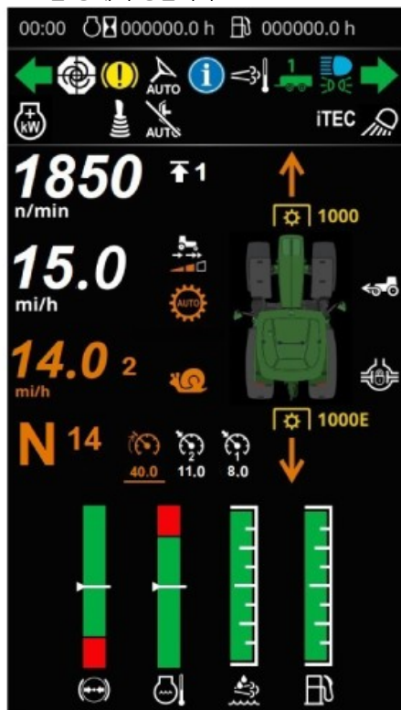
추가 CommandCenter 장착 코너 포스트 디스플레이.
