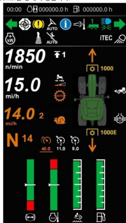
LX665578—UN—04MAR26 추가 CommandCenter 장착 코너 포스트 디스플레이.
