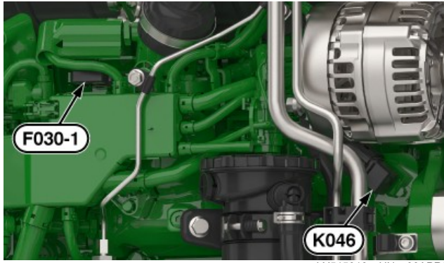
LX515016—UN—08APR24 전기 시동 보조장치의 글로우 플러그 퓨즈 및 릴레이(파인얼 티어 4 및 티어 3 엔진만 해당)
