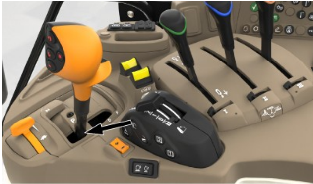
LX515133—UN—03OCT23 PowrQuad 또는 AutoQuad의 주차 잠금장치 체결
